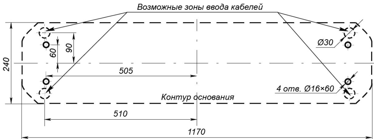
Рисунок 12. Схема разметки для установки стойки турникета<sup>1</sup>
