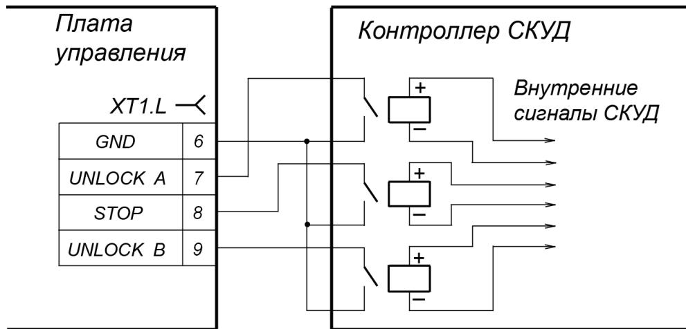
Рисунок 6. Управляющие элементы – нормально разомкнутый контакт реле
