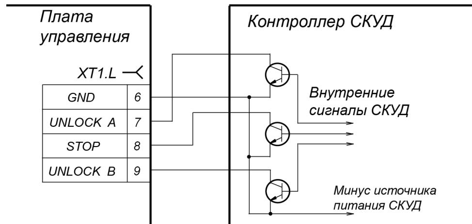
Рисунок 7. Управляющие элементы – схема с открытым коллекторным выходом
