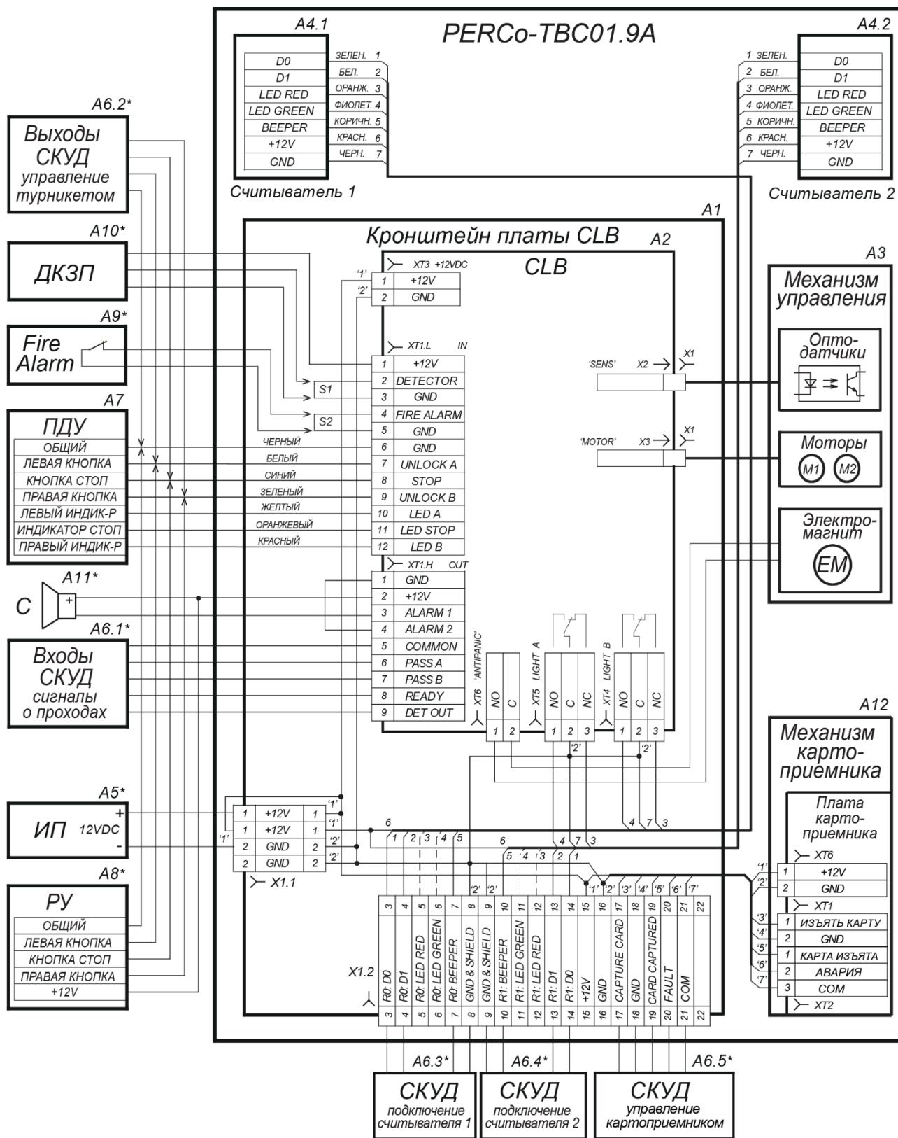
Рисунок 14. Схема электрических соединений турникета<sup>1</sup>
